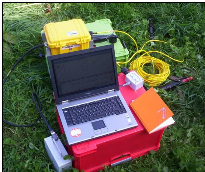
Figura 2: Strumentazione utilizzata per la prova MASW.
